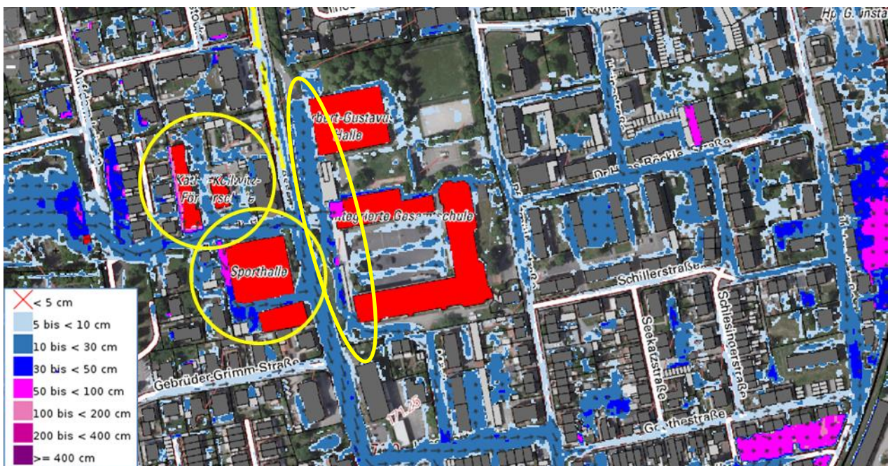
Abb. 176: Überflutungsgefährdete öffentlich und private Gebäude im Norden der Stadt, Sturzflutgefahrenkarte des Landes für SRI 7, 1 Std. von 11/2023 [1]
