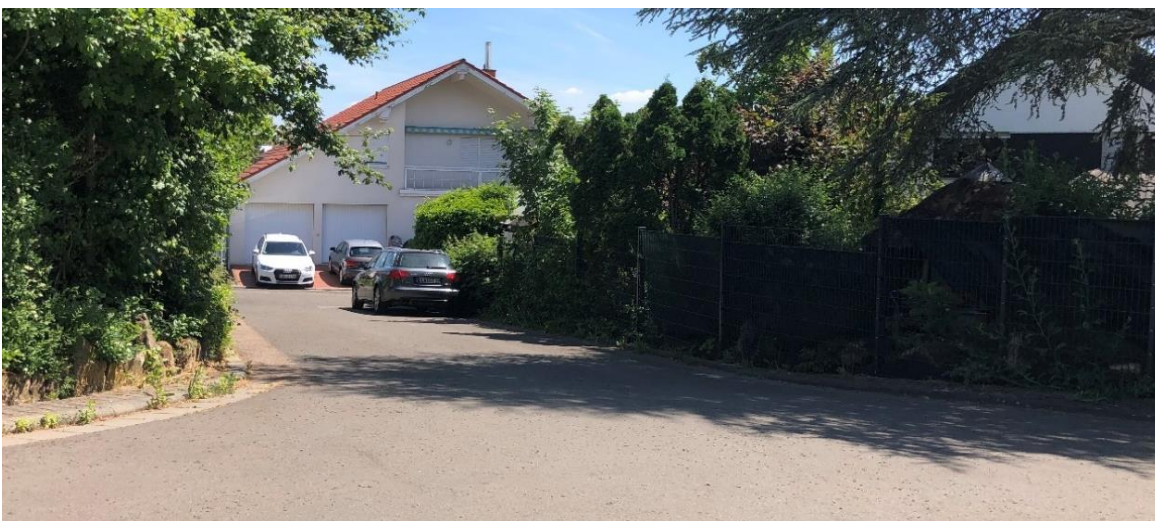
Abb. 17: Beispiel für Querbauung am Ende einer abschüssigen Straße
