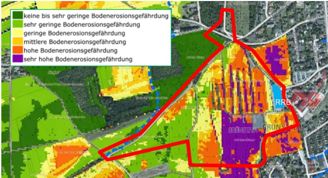
Abb. 191: Erosionsgefährdung im Einzugsgebiet des RRB Krankenhaus, Fruchtfolge 2016 - 2019, Landesamt für Geologie und Bergbau [4]
