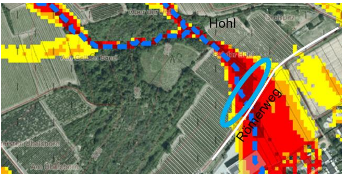
Abb. 59: Potenzieller Standort für Kleinrückhalte oder ein Rückhaltebecken, Starkregenkarte des Landes, 2019 [3]
